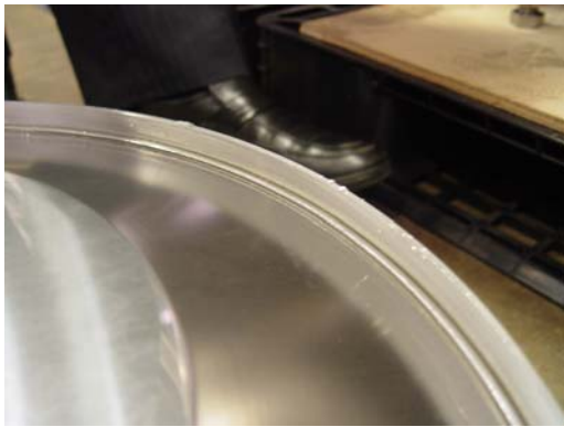
図4 釜のふち径より小さい蓋
